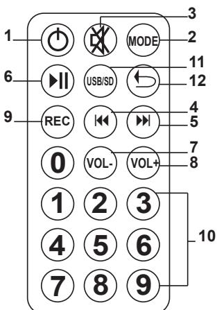
Tenga en cuenta que **el control remoto solo controla el reproductor multimedia, no otras fuentes de entrada** del dispositivo. Si el volumen está configurado al mínimo en el reproductor multimedia, no habrá salida de sonido, incluso si el control de volumen principal del altavoz está configurado al máximo.
